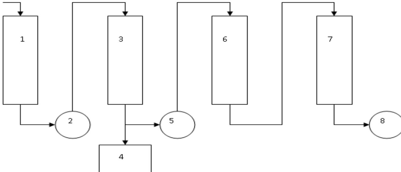
Схема процесса выделения стронция-90: 1 – растворение облученного топлива; 2;5 – корректировка кислотности раствора; 3 – первичное выделение стронция-90 на колонке со Sr Resin; 4 – емкость для хранения хвостового раствора; 6 – вторичная очистка стронция-90 на колонке со Sr Resin; 7 – очистка раствора стронция-90 от следов органики на колонке с катионитом; 8 – корректировка объема и кислотности раствора.
