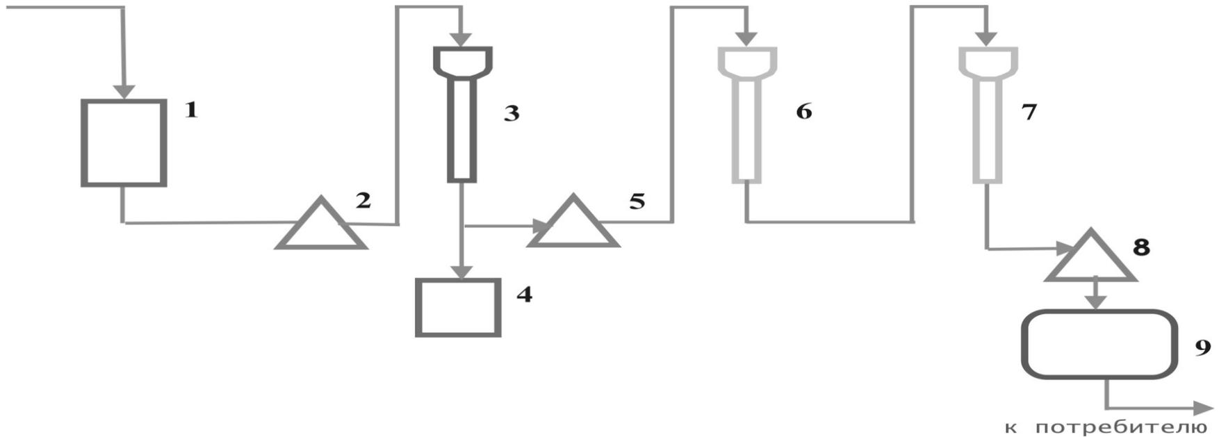
Схема процесса выделения Sr-89: 1 – растворение таблеток оксида иттрия; 2, 5, 8 – корректировка объема и кислотности раствора; 3 – первичная очистка Sr-89 на колонке со Sr Resin; 4 – емкость для хранения раствора иттрия; 6 – вторичная очистка Sr-89 на второй колонке со Sr Resin; 7 – очистка раствора Sr-89 от следов органики на колонке с катионитом; 9 – фасовка и упаковка готового продукта.
