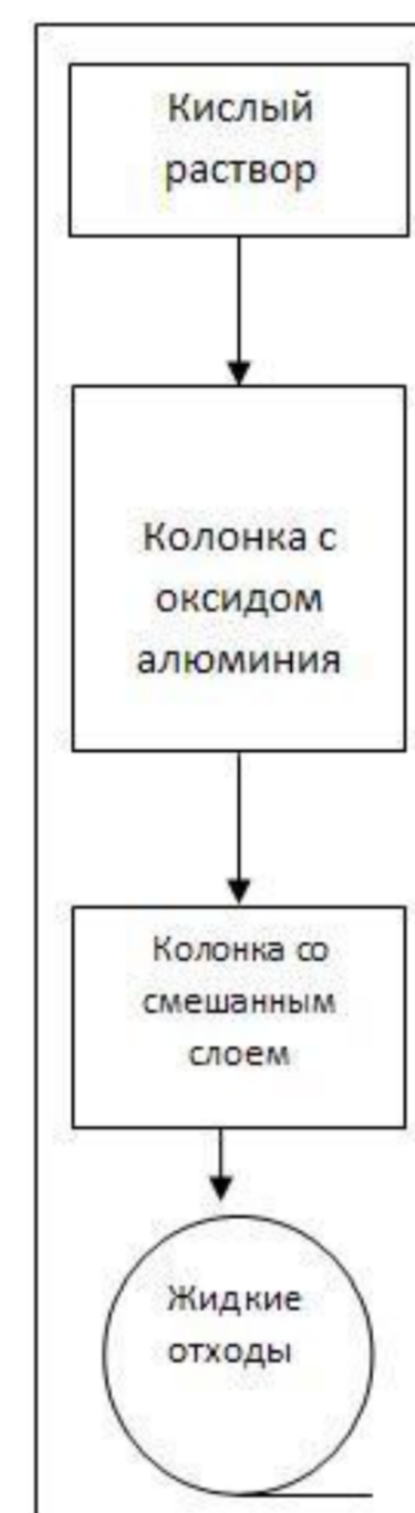
Рис. 1: Соединение колонки в производственном процессе
