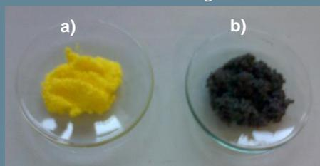
Рис. 1 : а) Смола AMP-PAN, б) Смола KNiFC-PAN
