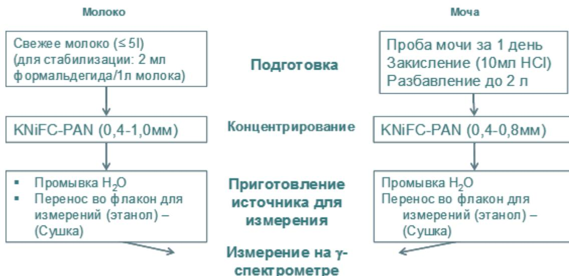
**Рис. 5: Схема выделения Cs из проб молока и мочи.**
