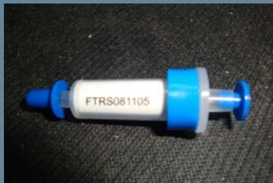
**Photo 1:** Nouvelle cartouche 2mL pour la résine TRU avec le code couleur bleu au niveau de la bague.
