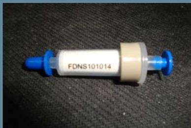
**Photo 2:** Nouvelle cartouche 2mL pour la résine DGA,N avec le code couleur gris au niveau de la bague.
