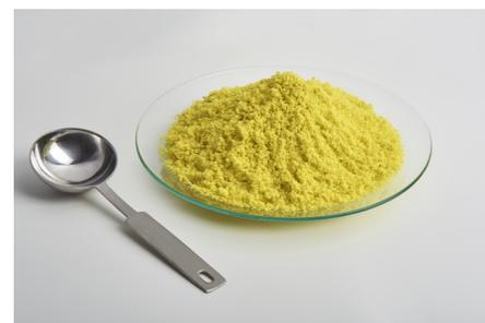
図1:半工業規模で生産されたAMP-PANレジンサンプル
