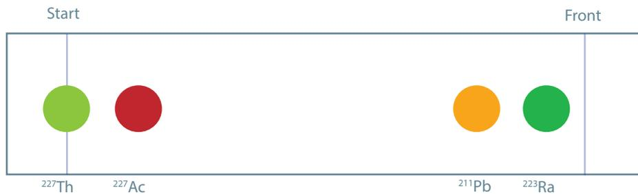
Esquema de una separación cromatográfica de una mezcla de Ac-227 y sus descendientes. El Th-227 permanece en el inicio, el Ac-227 tiene un factor de retención  $R_f$  de aproximadamente 0,2, el Pb-212 de aproximadamente 0,7 y el Ra-223 de aproximadamente 0,9.
