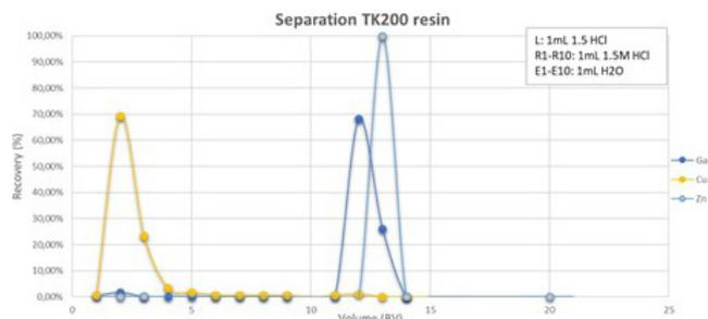
Estudio de elución, conversión de Ga en TK200 Resin, varios elementos, fracciones analizadas por ICP-MS
