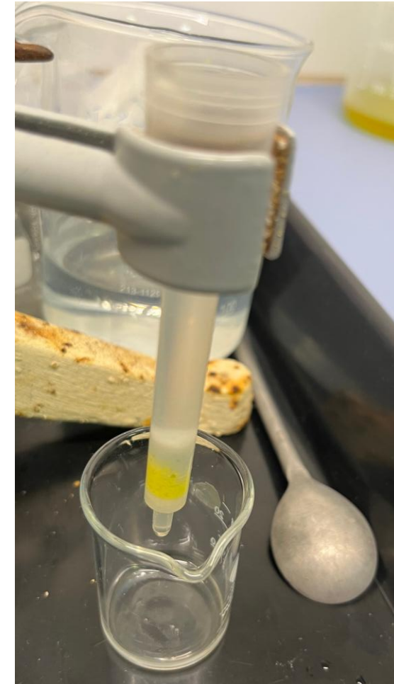
Cs-Elution von AMP-PAN resin
