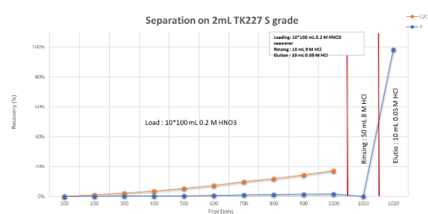
Figura 19 : Estudio de elución, 1 L de agua de mar, carga con 0.2 M HNO 3 , separación de Y, cartucho 2 mL TK227 Resin
